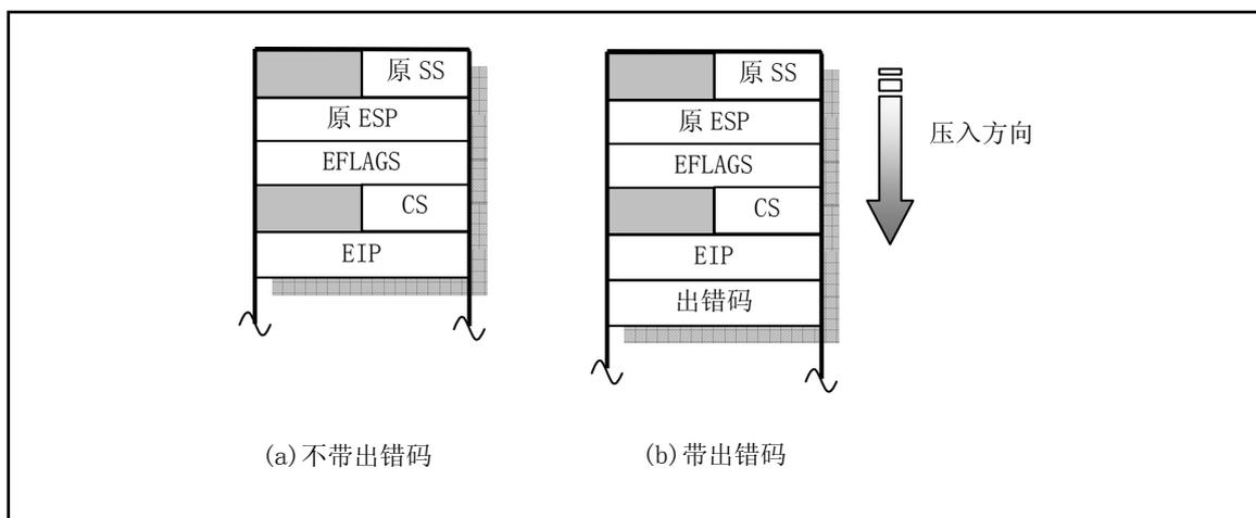
图 5-1 发生中断时堆栈中的内容
