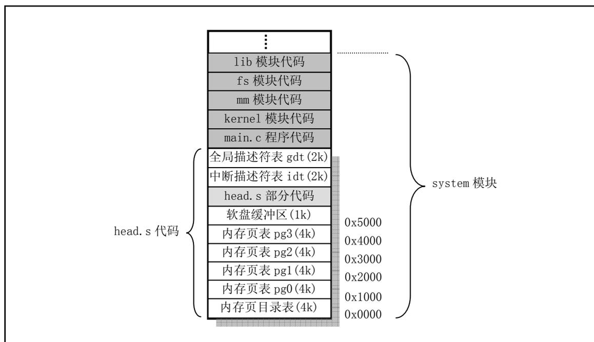
图 3-6 system 模块在内存中的映像示意图
