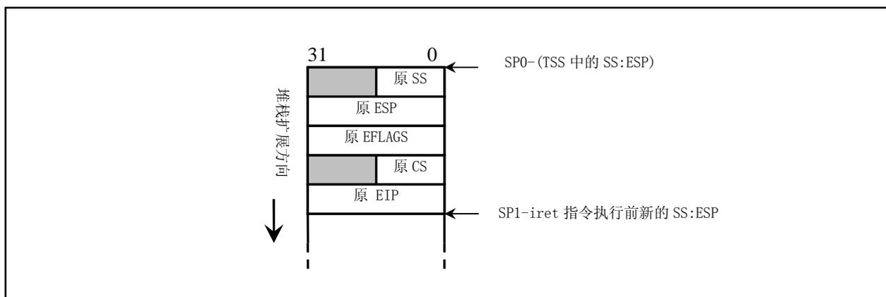
图 11-2 中断调用层间切换时堆栈内容
