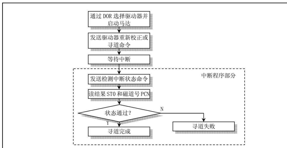
图 6-7 重新校正和寻道操作
