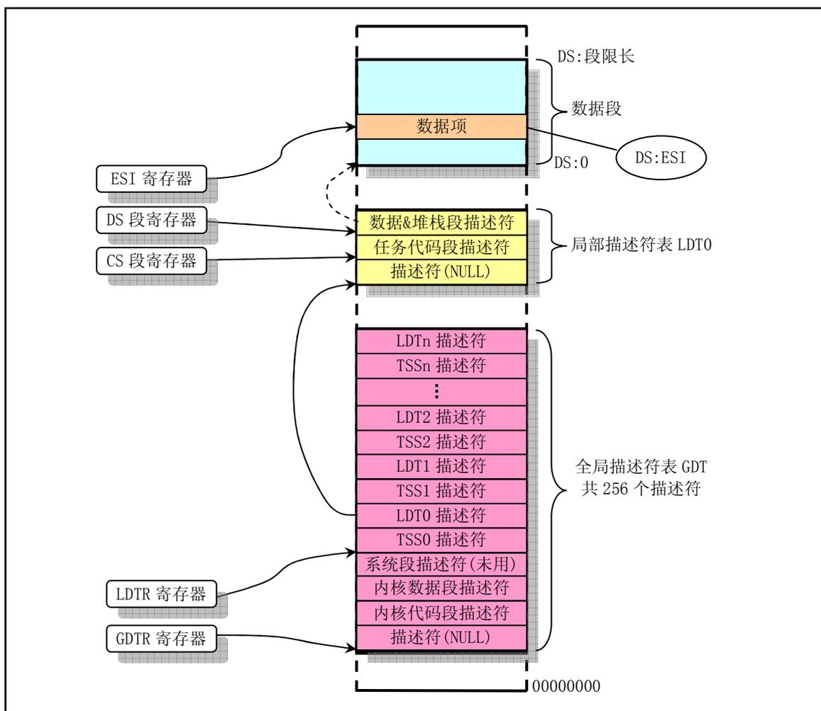
图 3-7 Linux 内核使用描述符表的示意图。
