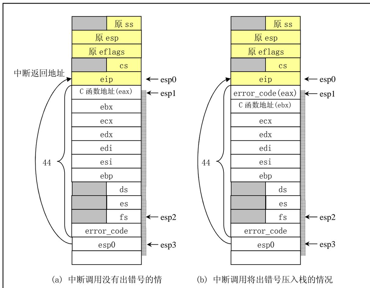
图 5-3 出错处理堆栈变化示意图
