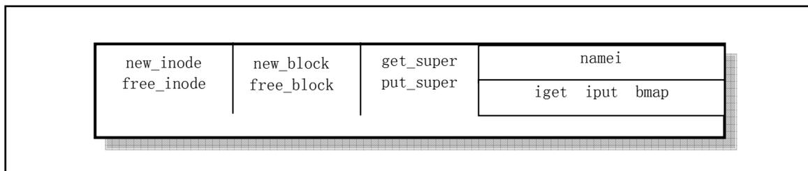
图 9-6 文件系统低层操作函数层次关系
