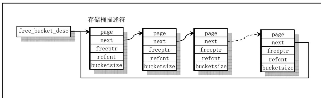
图 12-2 空闲存储桶描述符链表结构示意图
