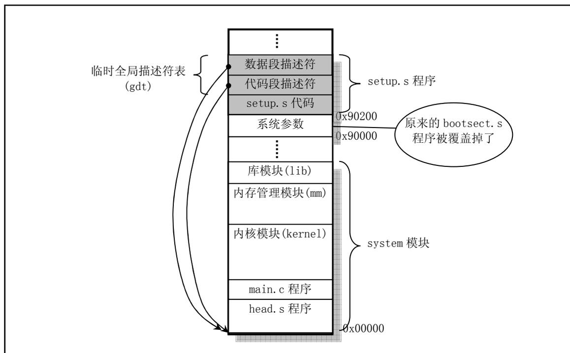
图 3-3 setup.s 程序结束后内存中程序示意图
