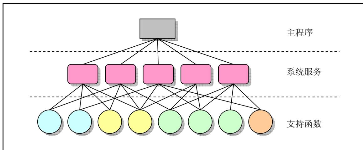
图 2-2 单内核模式的简单结构模型
