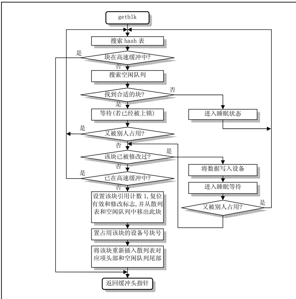
图 9-14 `getblk()` 函数执行流程图
