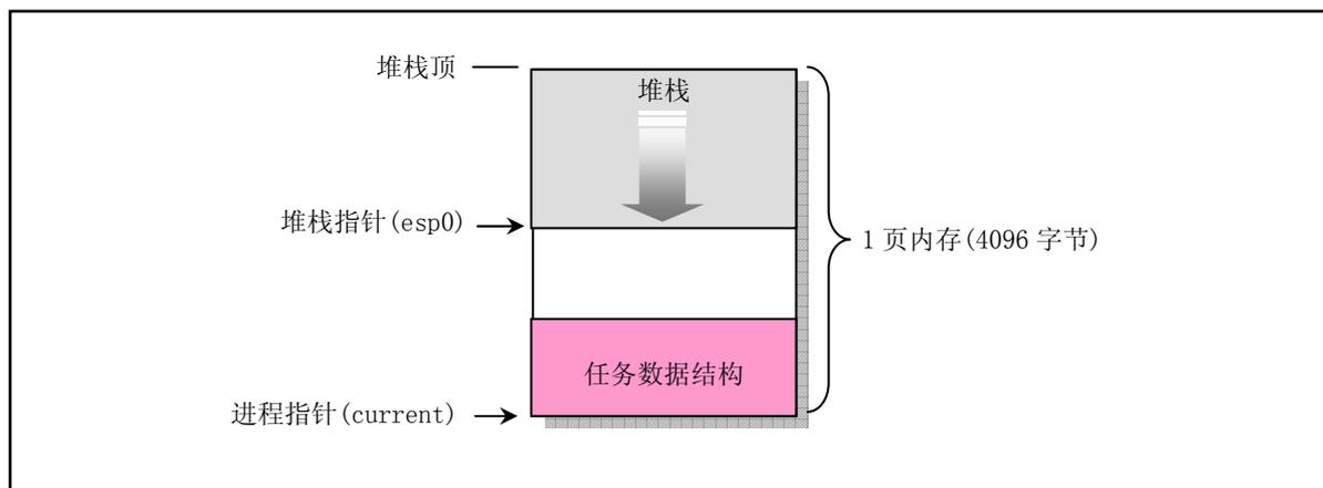
图 2-13 进程的内核态堆栈示意图
