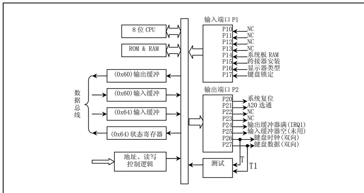
图 7-6 键盘控制器 804X 逻辑示意图
