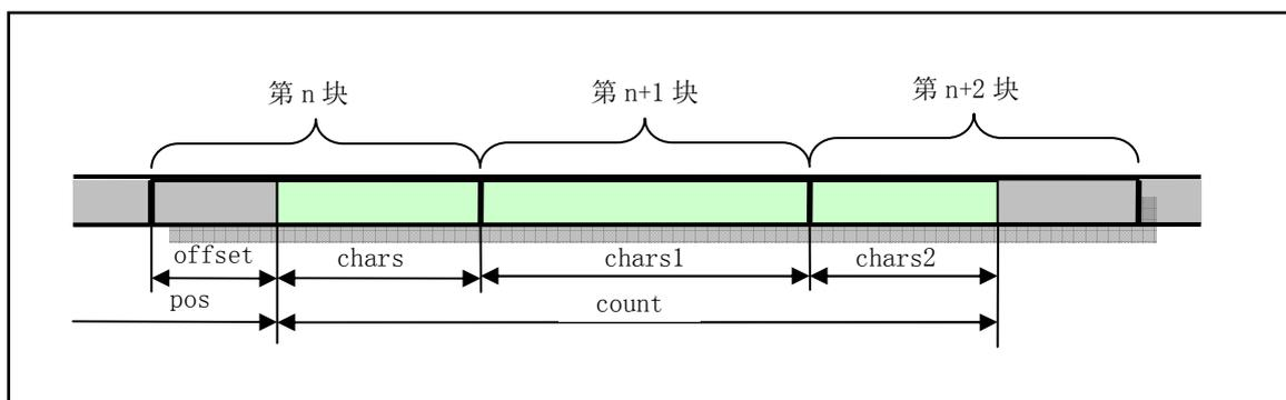
图 9-20 块数据读写操作指针位置示意图
