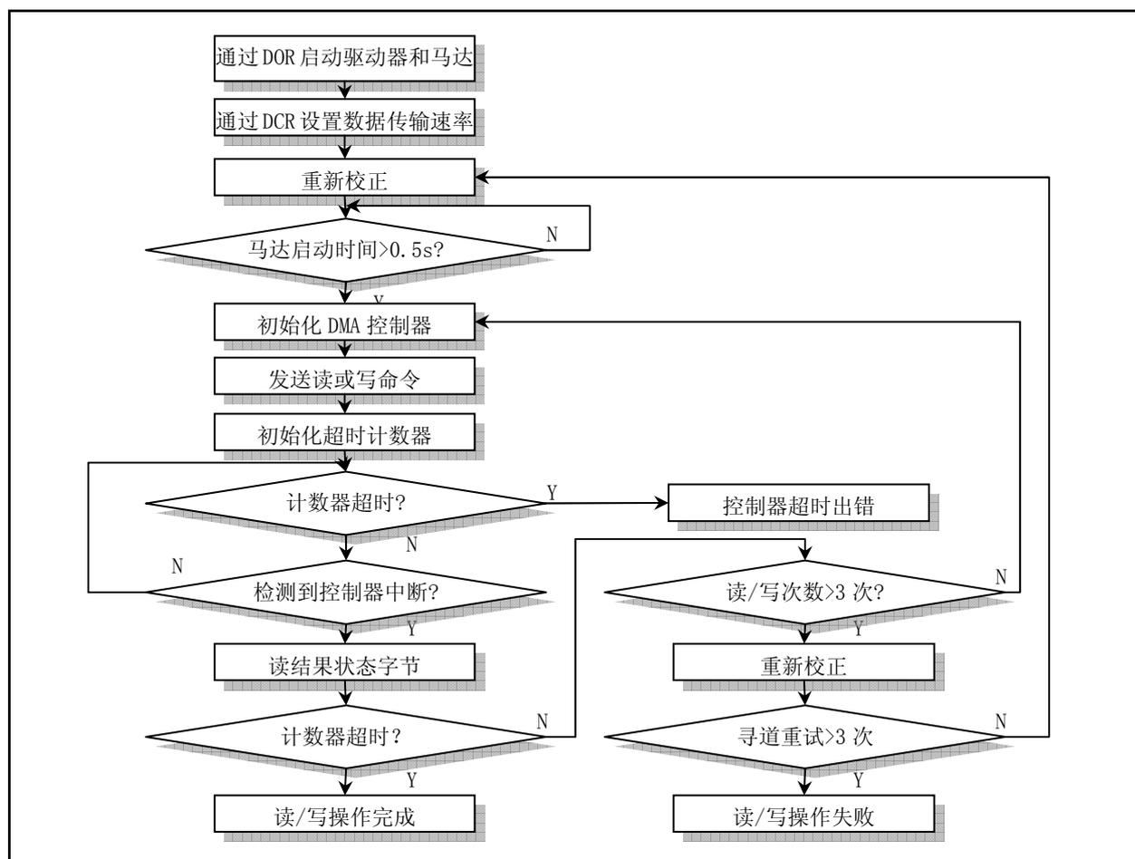
图 6-8 数据读/写操作流程图
