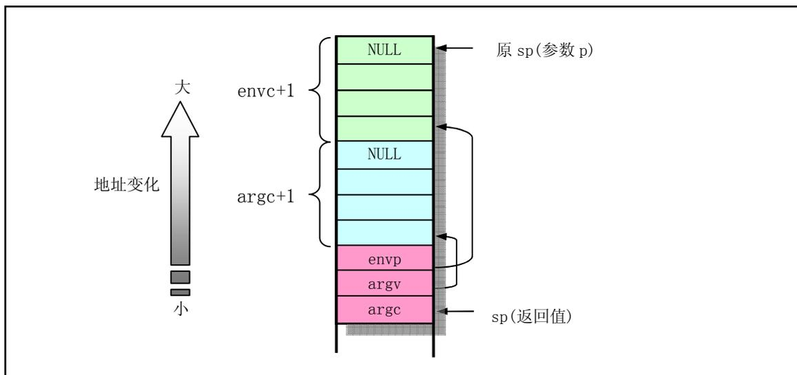
图 9-24 新程序堆栈中指针表示意图
