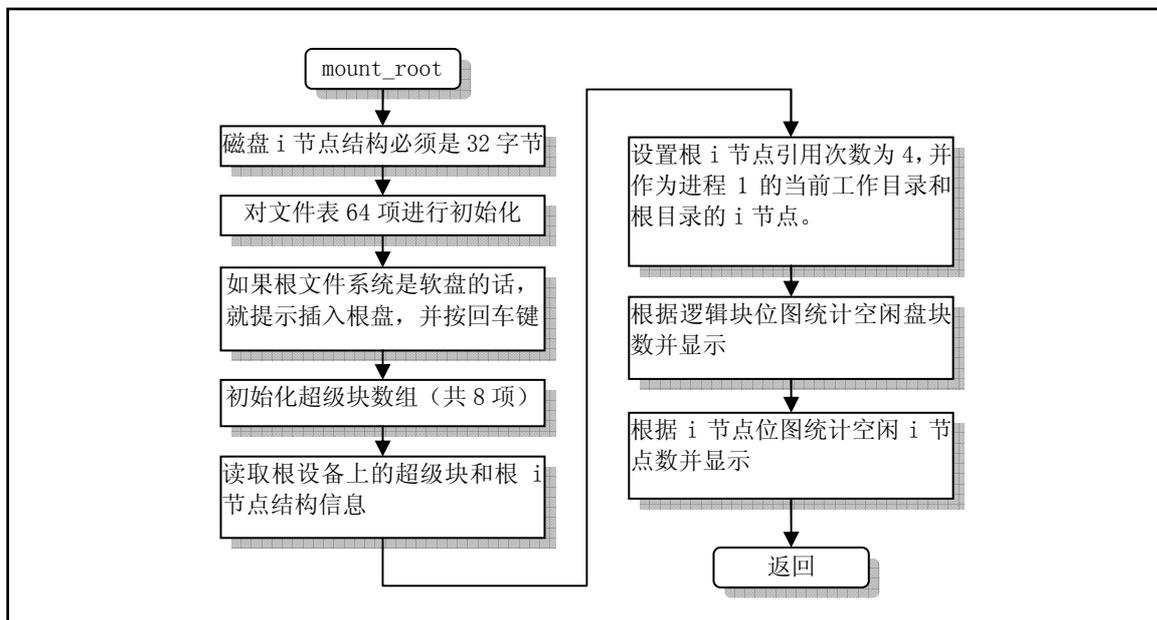
图 9-18 `mount_root()` 函数的功能
