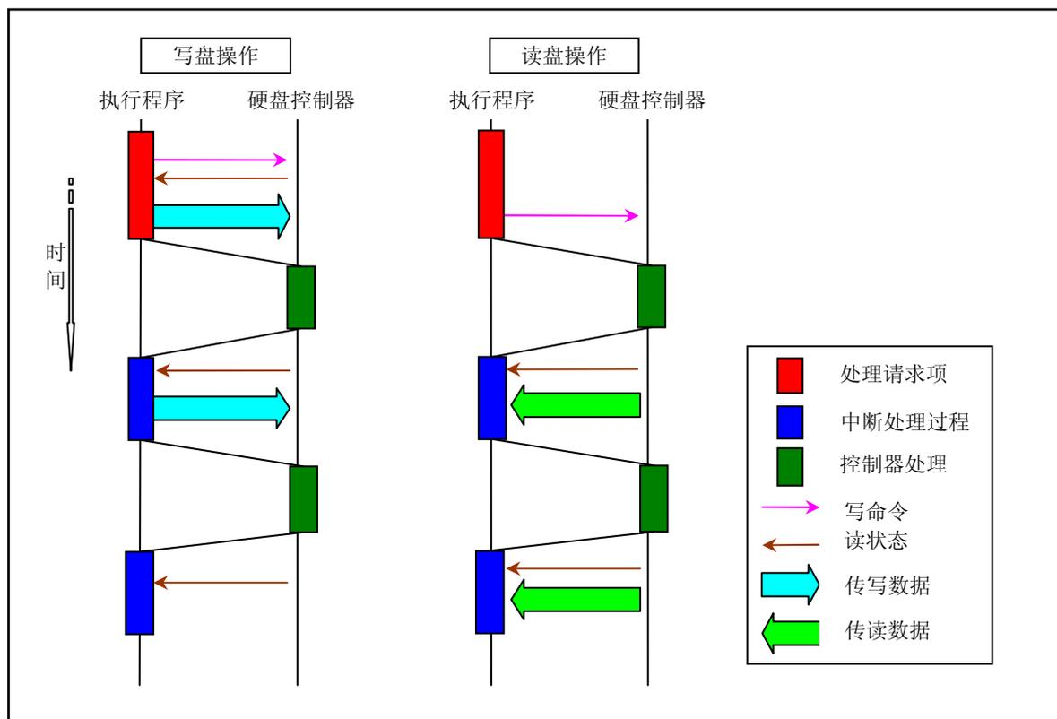
图 6-3 读/写硬盘数据的时序关系
