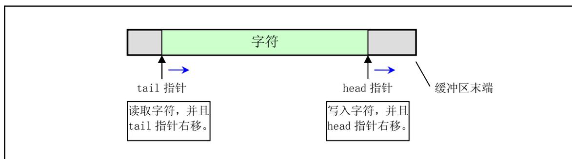
图 7-9 tty 字符缓冲队列的操作方式
