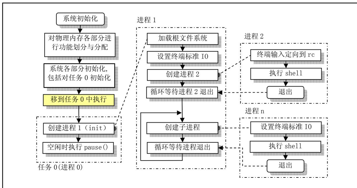
图 4-2 内核初始化程序流程示意图
