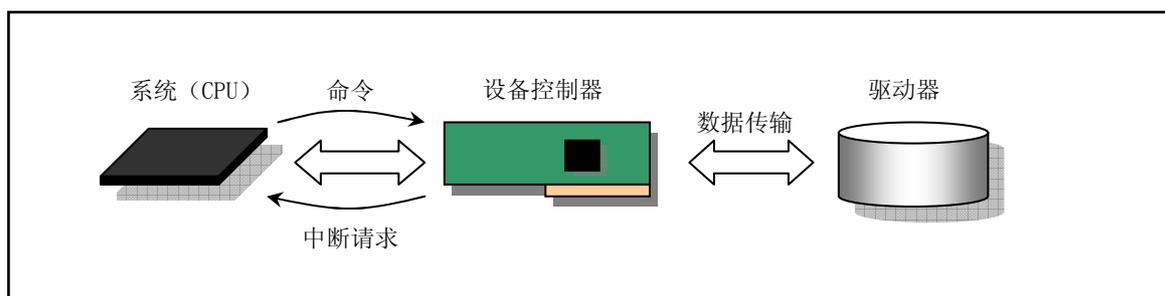
图 6-2 系统、块设备控制器和驱动器
