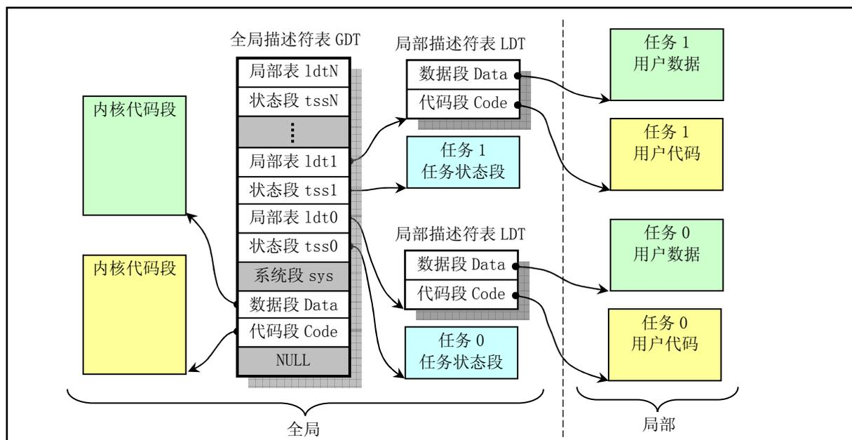
图 2-10 Linux 系统中虚拟地址空间分配图
