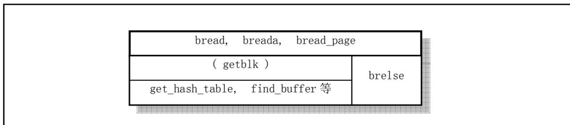
图 9-12 缓冲区管理函数之间的层次关系
