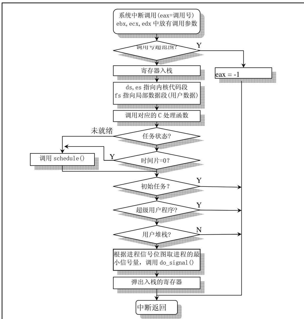
图 5-4 系统中断调用处理流程
