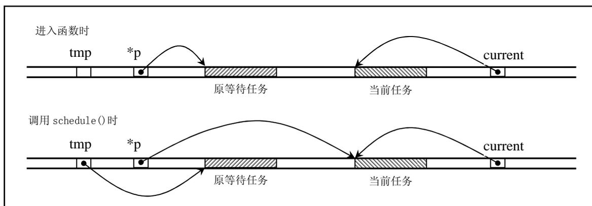
图 5-5 sleep\_on() 函数中指针变化示意图。
