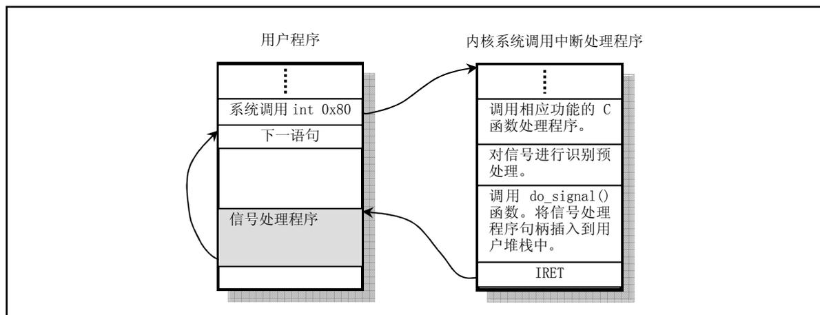
图 5-7 信号处理程序的调用方式。
