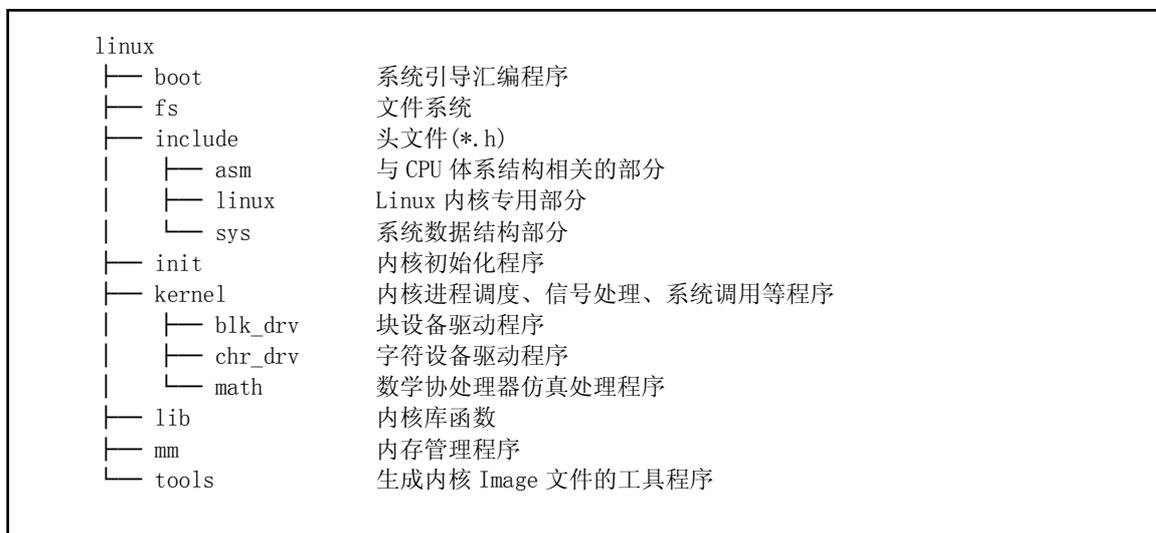
图 2-15 Linux 内核源代码目录结构
