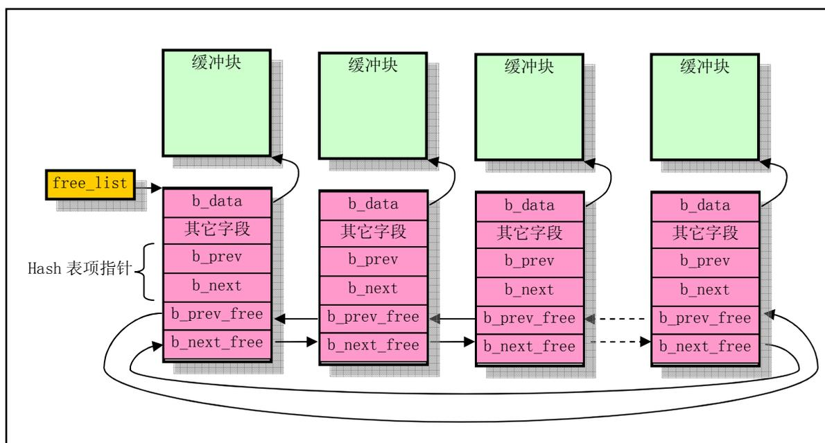
图 9-11 空闲缓冲块双向循环链表结构
