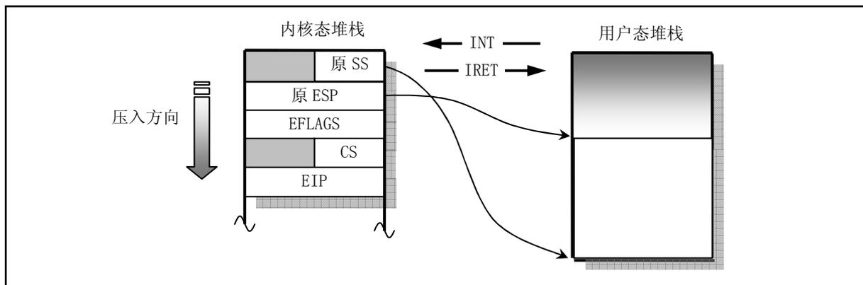
图 2-14 内核态和用户态堆栈的切换
