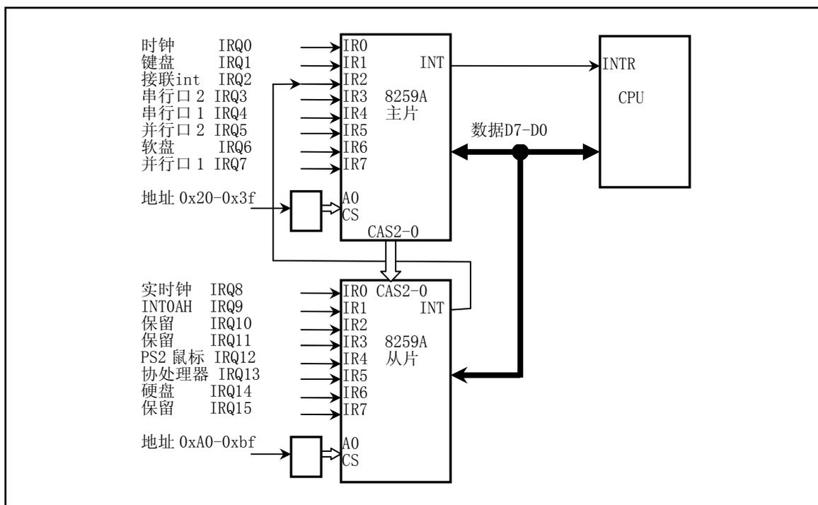
图 2-5 PC/AT 微机级连式 8259 控制系统
