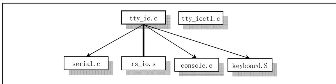
图 2-19 字符设备程序之间的关系示意图
