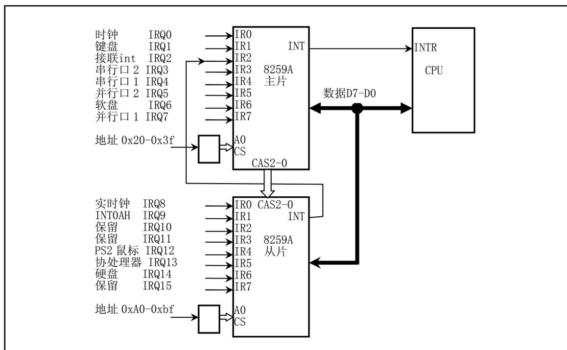
图 3-4 PC/AT 微机级连式 8259 控制系统
