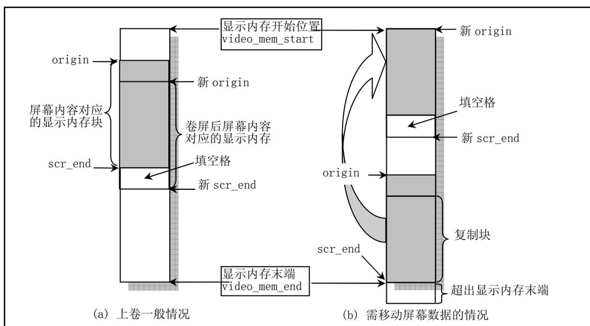
图 7-7 向上卷屏(scroll up)操作示意图
