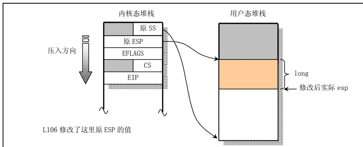
图 5-8 do\_signal() 函数对用户堆栈的修改
