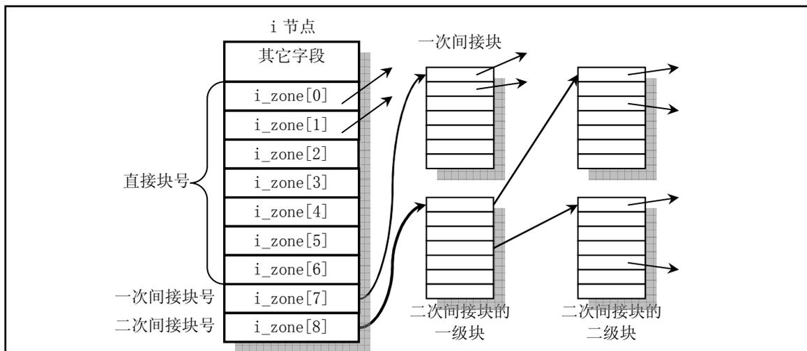
图 9-4 i 节点的逻辑块（区块）数组的功能
