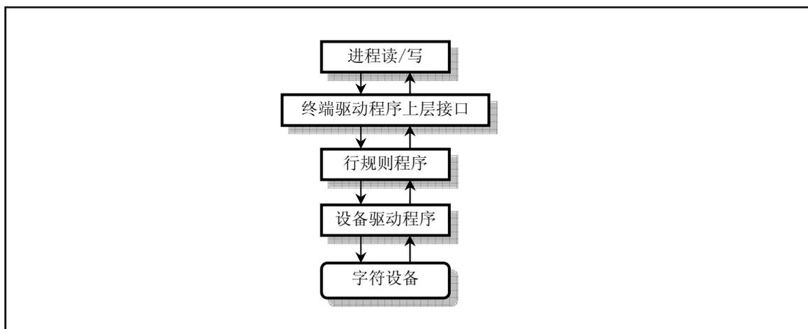
图 7-1 终端驱动程序控制流程
