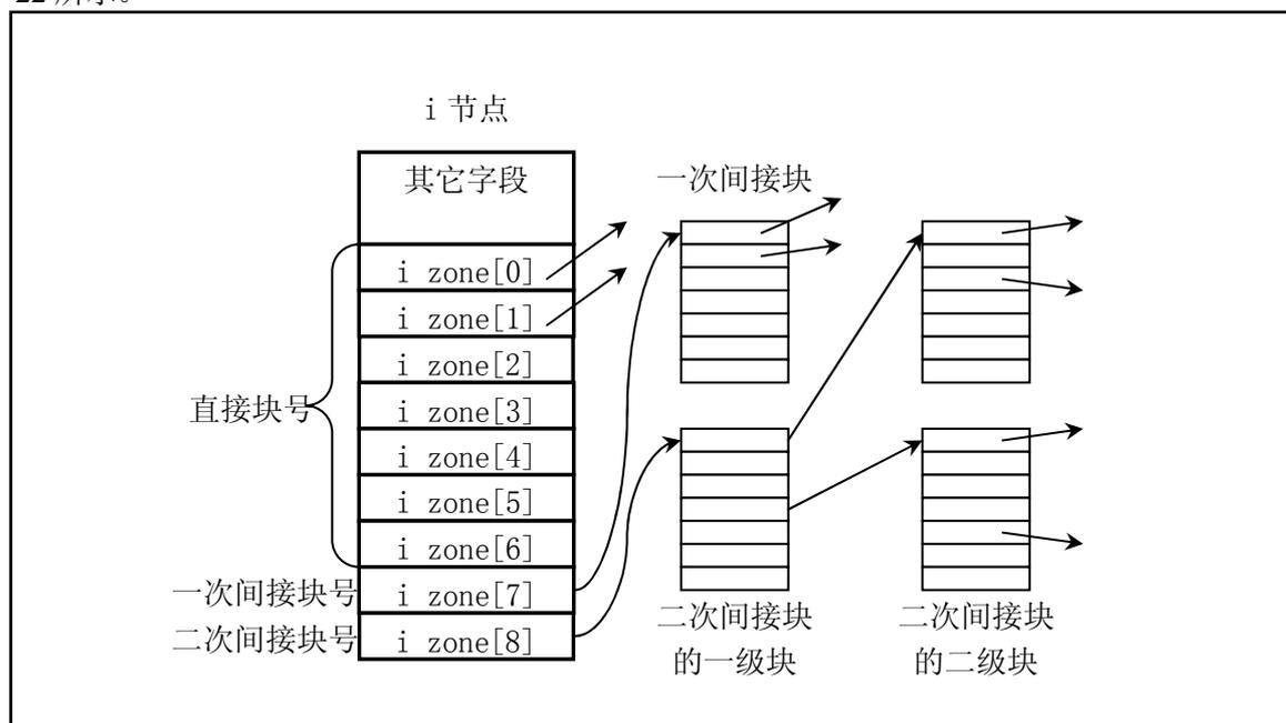
图 9-22 索引节点(*i* 节点)的逻辑块连接方式
