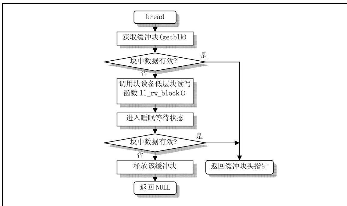
图 9-15 `bread()` 函数执行流程框图
