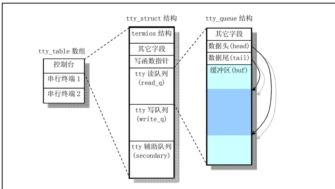
图 7-2 终端程序的数据结构
