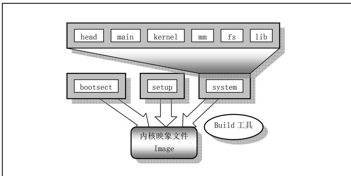
图 2-20 内核编译连接/组合结构
