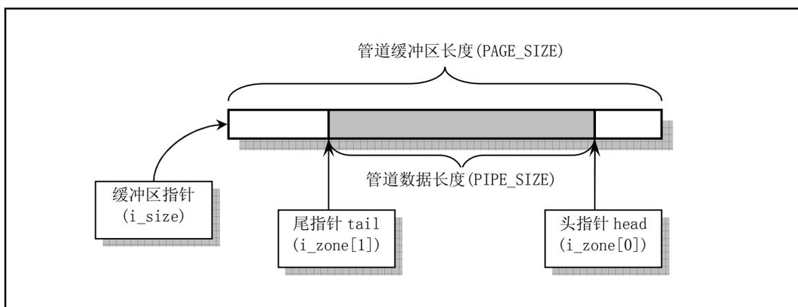
图 9-21 管道缓冲区操作示意图
