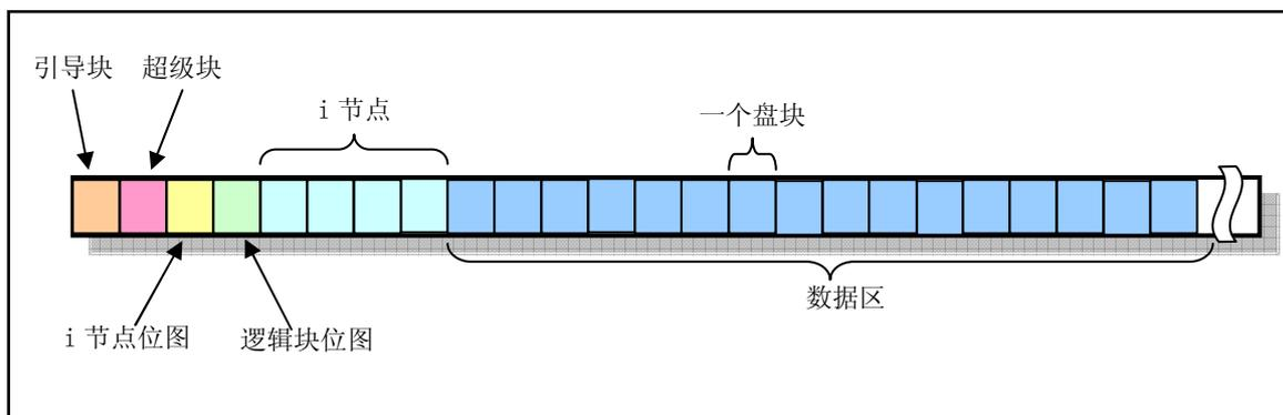
图 9-1 建有 MINIX 文件系统的 360K 软盘中文件系统各部分的布局示意图
