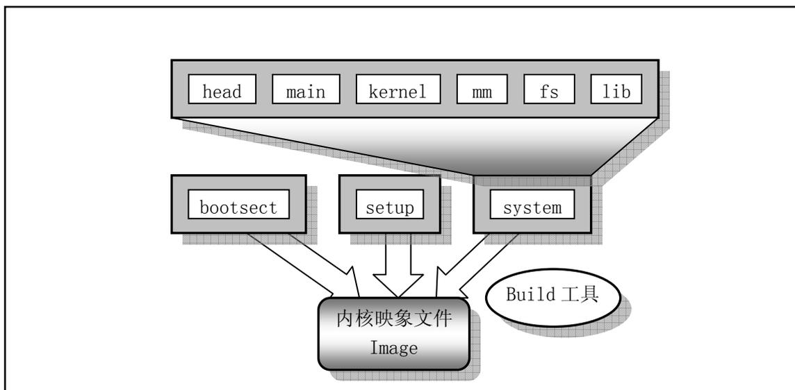
图 13-1 内核编译连接/组合结构
