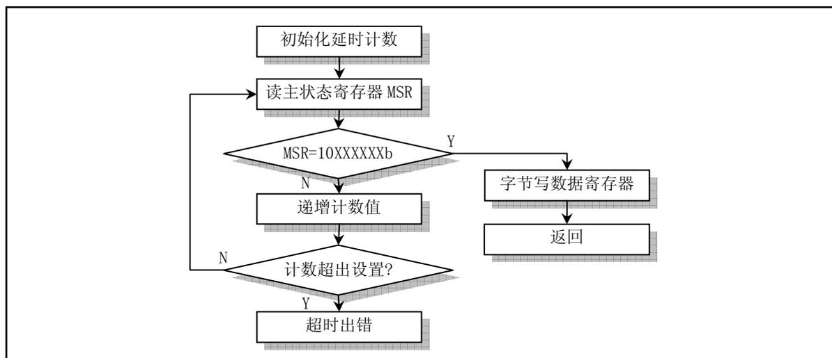
图 6-6 向软盘控制器发送命令或参数字节
