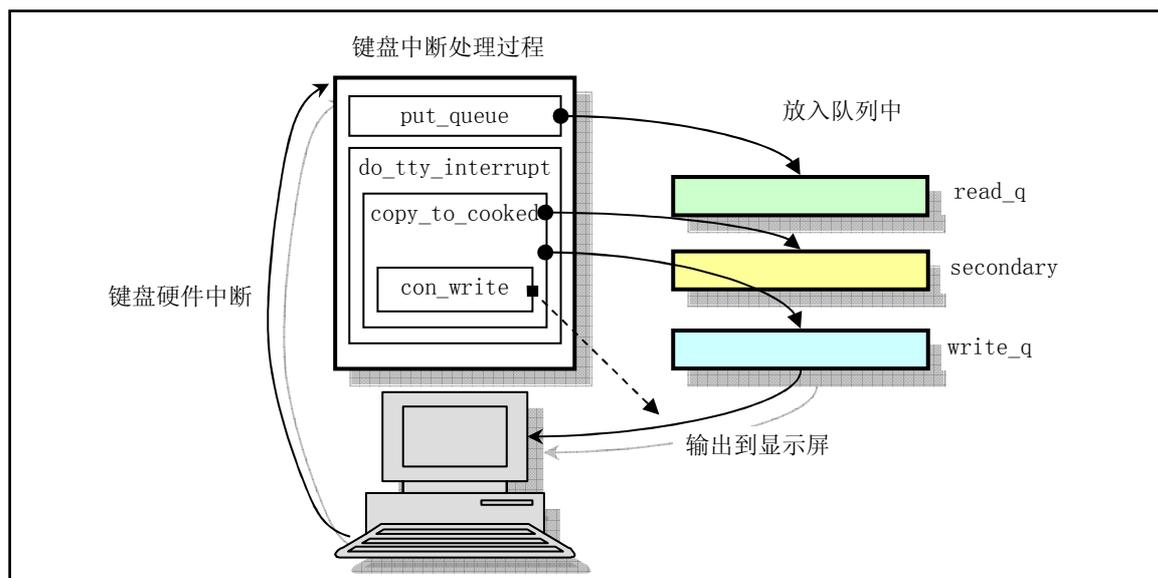
图 7-3 控制台键盘中断处理过程
